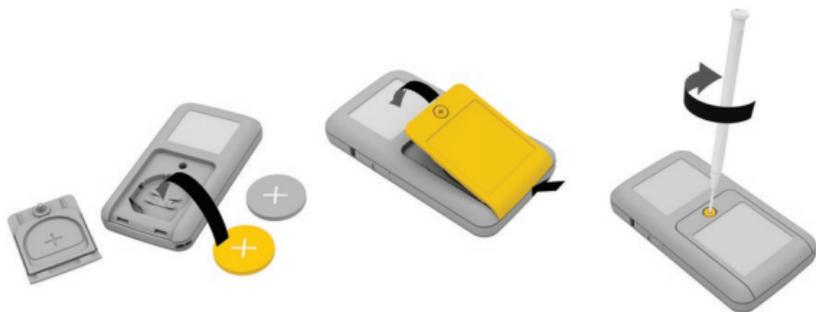
3. Inserte con cuidado la pila nueva con el polo positivo “+” hacia arriba.
