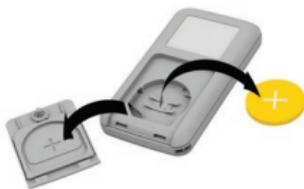
2. Retire la tapa y la pila usada.
