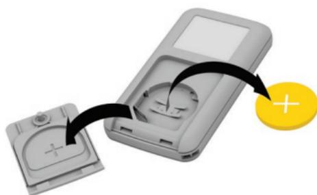
2. Retire a tampa da bateria deslizando-a e remova a bateria.
