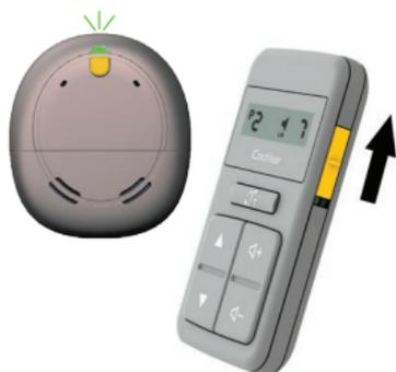
1. Ligue o processador e o controle remoto. Ambos devem estar "acordados" e ligados durante a conexão inteira.
