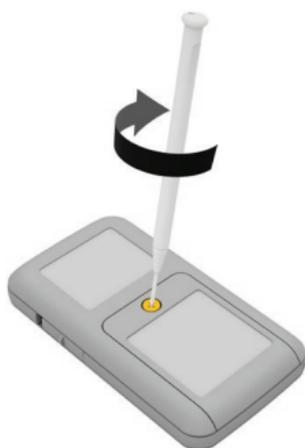
5. Bloquee a tampa da bateria girando o parafuso em sentido horário com uma chave de fenda Phillips pequena até que fique bem ajustado.
