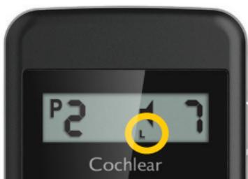
4. O controle remoto mostrará sua conexão bem sucedida com o processador esquerdo (L) ou direito (R).
