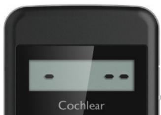
Se o controle remoto não estiver conectado a algum processador, seu visor mostrará traços (exibidos à esquerda) e "piscará" quando você pressionar os botões.
