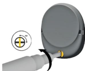
1. Se a tampa da bateria estiver bloqueada, gire o parafuso de bloqueio no sentido anti-horário para desbloqueá-la.
