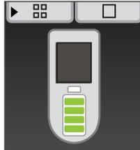
Figura 4: la pantalla de nivel de la pila indica que la pila está totalmente cargada
