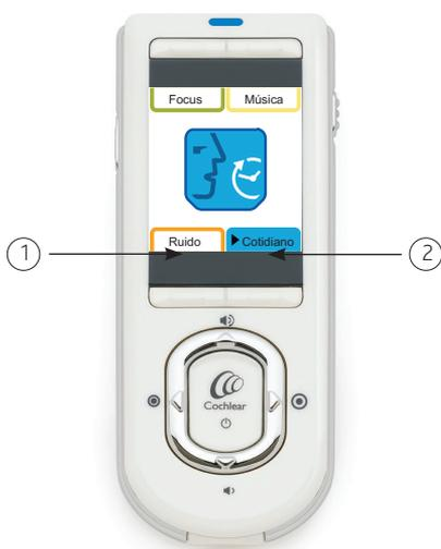
Figura 22: teclas de dirección para disminuir (1) y aumentar (2) la sensibilidad
