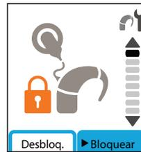
Figura 47: teclas del procesador bloqueadas
