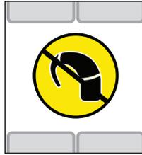
Figura 15: indica que el mando a distancia no está dentro de la distancia operativa, hay interferencias o el procesador no está disponible
