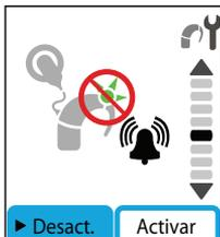
Figura 52: el indicador luminoso de alarmas y pulsaciones de teclas está desactivado (off)
