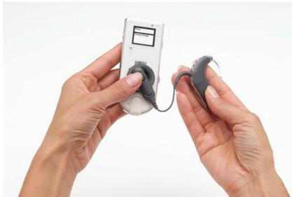
Figura 12: colocar la bobina en las guías del sensor de la bobina
