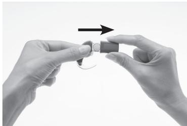
1. Apague su procesador. Si el compartimento de las pilas o la tapa de las pilas están bloqueados, desbloquéelos.
