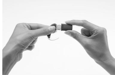
2. Retire la tapa de las pilas del portapilas.
