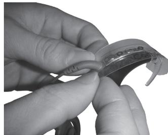
5. Inserte el extremo inferior del aplicador (el lado con una abertura) a través del cable de la bobina.
