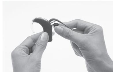
2. Coloque los dedos sobre las zonas de agarre del cable del accesorio de audio.
