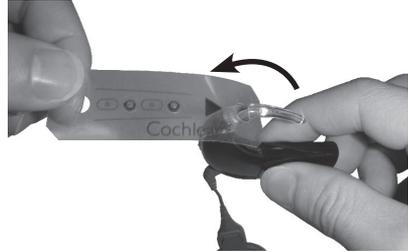
2. Asegúrese de que el codo y el cable de la bobina están acoplados a su unidad de procesamiento.
