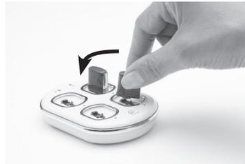
1. Extraiga el compartimento de la pila de la unidad de procesamiento.
