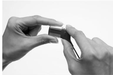
3. Inserte el compartimento de las pilas en la funda LiteWear empujando suavemente en el extremo inferior del conector del cable. Se puede insertar por ambos lados.
