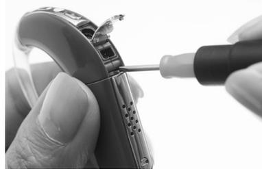
1. Levante la tapa de la entrada de accesorios del procesador. El bloqueo está situado debajo de la entrada de accesorios.
