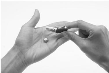
3. Retire las pilas desechables (pilas de cinc-aire) del portapilas.
