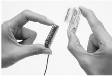
1. Si todavía no hay ningún auxiliar de fijación LiteWear acoplado a la funda LiteWear, acóplelo antes de introducir el compartimento de las pilas en la funda LiteWear. Para más información, véase *Acoplar y desacoplar el auxiliar de fijación LiteWear*.
