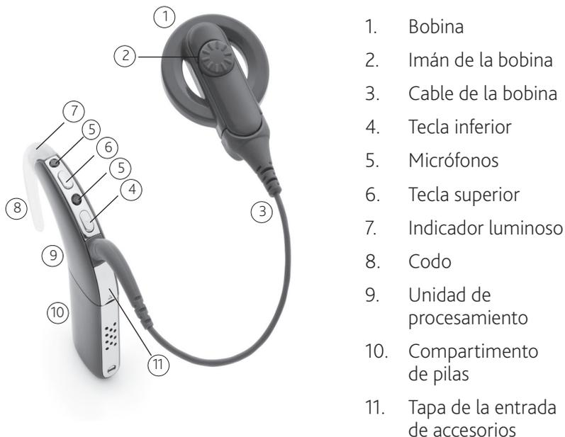
Figura 1: partes del procesador de sonido CP810
