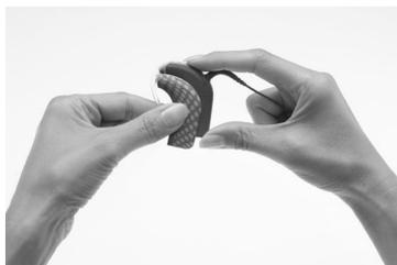
1. Sujete el procesador con una mano y la carcasa con la otra, tal como se muestra.
