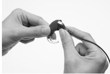
2. Sujete la unidad de procesamiento y el conector superior del cable LiteWear (el extremo del cable que se conectará a la unidad de procesamiento) de manera que se toquen. El conector superior debe quedar a la izquierda de la posición final, y la unidad de procesamiento a la derecha de la posición final.
