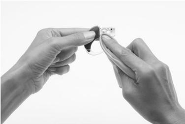
4. Limpie el portapilas y la tapa de las pilas (por dentro y por fuera) con un paño suave y seco para eliminar cualquier resto de agua, humedad o sudor.
