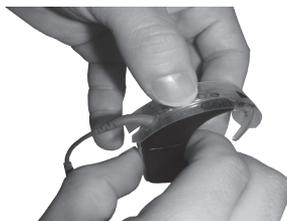
7. Presione con el pulgar los protectores del micrófono de uno en uno hasta que encajen en los orificios.
