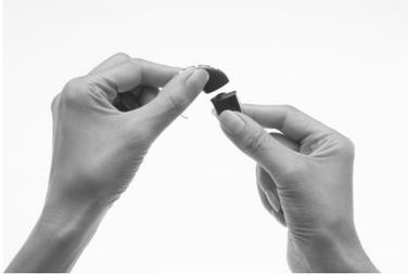
1. Si el compartimento de las pilas está acoplado a la unidad de procesamiento, desacóplelo.
