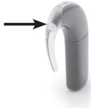
1. Retire el codo de la unidad de procesamiento empujando el extremo inferior del mismo hacia la unidad de procesamiento.
