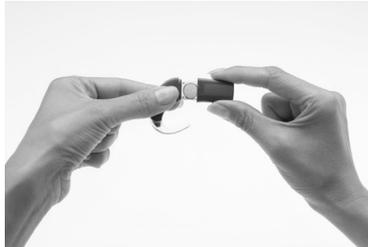
6. Vuelva a colocar la tapa de las pilas deslizándola hacia arriba desde la parte inferior del portapilas hasta la unidad de procesamiento. No fuerce la tapa al introducirla; debería deslizarse fácilmente.
