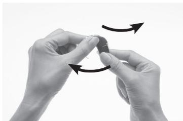
1. Sujete el compartimento de las pilas y la unidad de procesamiento tal como se muestra. Si el compartimento de las pilas está bloqueado, deberá desbloquearlo tal como se describe en el apartado *Bloquear y desbloquear el compartimento de las pilas*.
