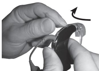
8. Extraiga el aplicador despegándolo cuidadosamente hacia arriba desde el extremo del cable de la bobina.
