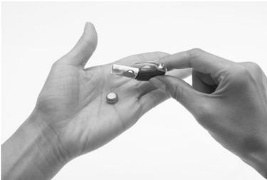
3. Entnehmen Sie die Einwegbatterien (Zink-Luft-Batterien) aus dem Batteriehalter.
