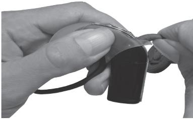
1. Halten Sie die Soundprozessor-Einheit in der einen und das Sendespulenkabel in der anderen Hand, wie in der Abbildung dargestellt.
