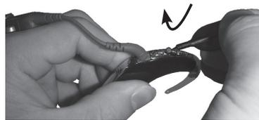
1. Entfernen Sie die Schutzabdeckung von der Entnahmehilfe für Mikrofonschutz-Elemente.
