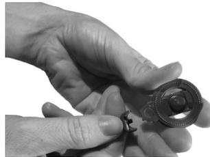
1. Halten Sie die Sendespule und das Sendespulenkabel so, dass die Unterseite der Sendespule nach oben zeigt. Wenn Sie den Fingernagel in den Zwischenraum zwischen Sendespule und Sendespulenkabel an der Unterseite der Sendespule schieben, erleichtert das die Trennung von Sendespule und Sendespulenkabel.
