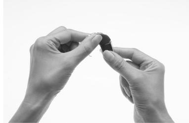
2. Drehen Sie das Batterie- bzw. Akkumodul und die Soundprozessor-Einheit, bis sie einrasten.
