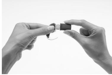
2. Entfernen Sie die Batterieabdeckung vom Batteriehalter.
