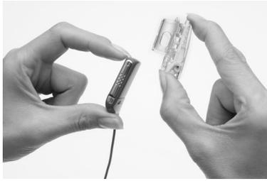
1. Falls LiteWear-Schutzgehäuse und LiteWear-Fixierhilfe noch nicht zusammengesetzt wurden, setzen Sie diese noch vor dem Einführen des Batteriemoduls in das LiteWear-Schutzgehäuse zusammen. Weitere Informationen finden Sie im Abschnitt *LiteWear-Fixierhilfe anbringen und abtrennen*.
