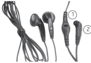
Abbildung 16: Zubehör-/FM-System-Stecker (1) und Soundprozessor-Stecker (2) an den Kontrollkopfhörern
