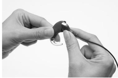
2. Halten Sie die Soundprozessor-Einheit und den oberen Anschluss-Schuh des LiteWear-Kabels (das an die Soundprozessor-Einheit anzuschließende Kabelende) so, dass sie einander berühren. Der obere Kabelanschluss sollte sich links, und die Soundprozessor-Einheit sollte sich rechts von der endgültigen Position befinden.
