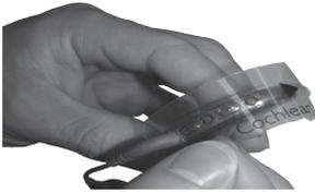
6. Stellen Sie sicher, dass die Markierungen am Applikator auf die Tasten und den Rücken der Soundprozessor-Einheit ausgerichtet sind.
