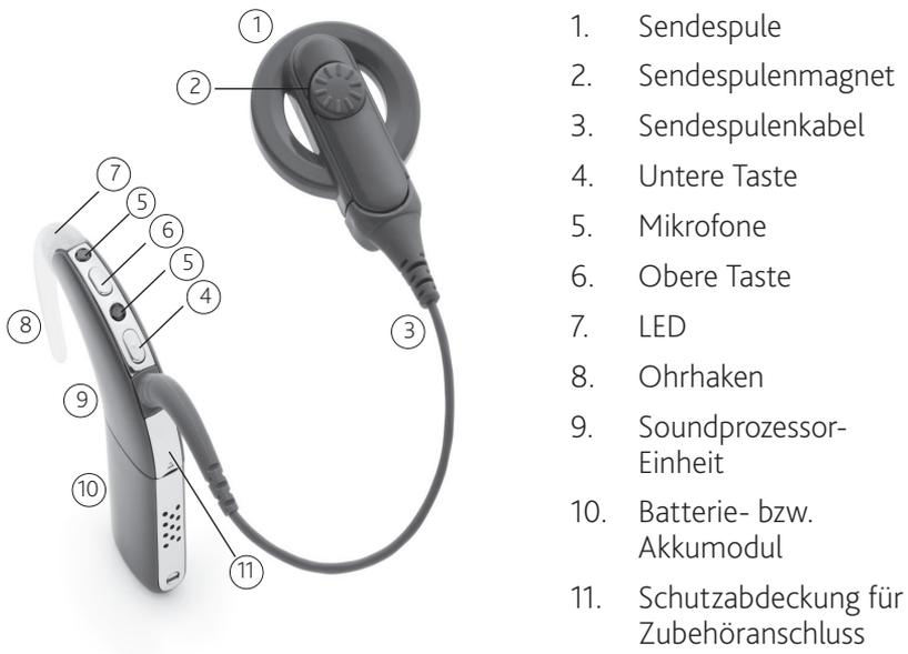
Abbildung 1: Teile des CP810 Soundprozessors
