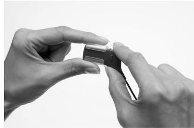
3. Führen Sie das Batteriemodul in das LiteWear-Schutzgehäuse ein. Drücken Sie dazu vorsichtig auf das untere Ende des Kabelanschluss-Schuhs. Das Batteriemodul kann aus beiden Richtungen eingeführt werden.
