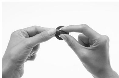
5. Setzen Sie den neuen Magneten vorsichtig in die Magnetaussparung auf der Oberseite der Sendespule ein. Dabei sollte die Seite mit dem Stern nach oben zeigen. Der Magnet sollte sich leicht einsetzen lassen.
