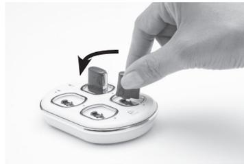
1. Entfernen Sie das Akkumodul von der Soundprozessor-Einheit.
