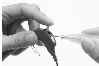
1. Schließen Sie das LiteWear-Kabel an die Soundprozessor-Einheit an.
