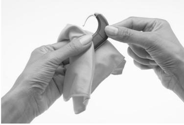
1. Wischen Sie den Soundprozessor vor dem Abnehmen der Batterieabdeckung mit einem weichen, trockenen Tuch ab.
