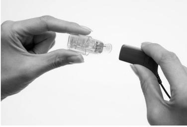
1. Nehmen Sie das Batteriemodul vom LiteWear-Schutzgehäuse ab.
