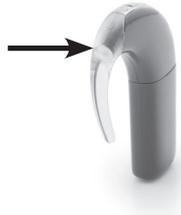
1. Nehmen Sie den Ohrhaken von der Soundprozessor-Einheit ab, indem Sie sein unteres Ende in Richtung der Soundprozessor-Einheit drücken.
