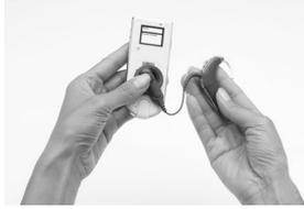
Abbildung 14: Aufsetzen der Sendespule auf die Rückseite der Fernbedienung
