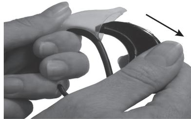
4. Entfernen Sie den Snugfit, indem Sie die Soundprozessor-Einheit vorsichtig vom Snugfit abziehen.
