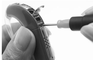
1. Heben Sie die Schutzabdeckung für den Zubehörschluss des Soundprozessors an. Die Verriegelung befindet sich unterhalb des Zubehörschlusses.
