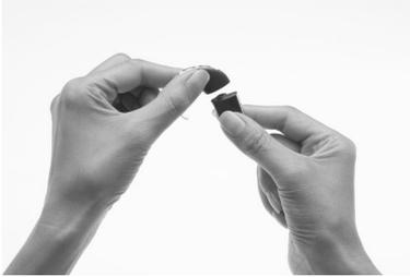
1. Wenn das Batterie- bzw. Akkumodul mit der Soundprozessor-Einheit verbunden ist, nehmen Sie das Batteriemodul ab.
