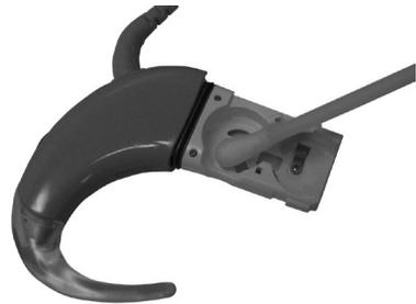
1. Entnehmen Sie die Batterien aus dem Batteriehalter.
