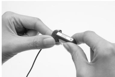
5. Drehen Sie den unteren Anschluss-Schuh des LiteWear-Kabels vorsichtig nach rechts und das Batteriemodul nach links, bis beide Teile voneinander getrennt sind.
