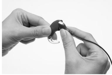
3. Drehen Sie den oberen Anschluss-Schuh des LiteWear-Kabels vorsichtig nach links und die Soundprozessor-Einheit nach rechts, bis beide Teile voneinander getrennt sind.
