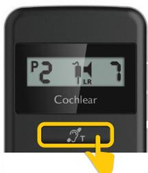
Para iniciar el streaming de audio, efectúe una pulsación larga en la tecla de la telebobina.
