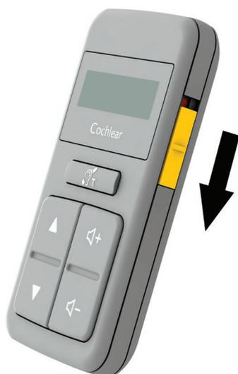
Para apagar deslice el interruptor hacia abajo.
