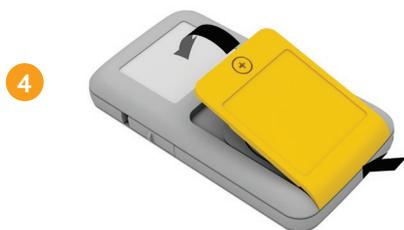
Vuelva a colocar la tapa de las pilas, primero el borde inferior.
