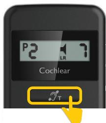
Para detener el streaming de audio, pulse brevemente la tecla de la telebobina.
