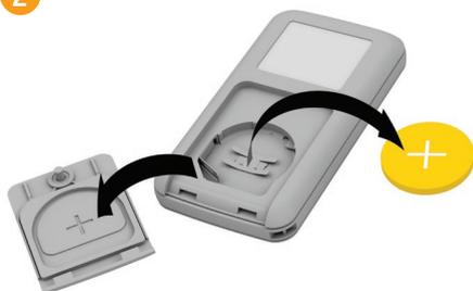
Retire la tapa de las pilas deslizándola y saque la pila.
