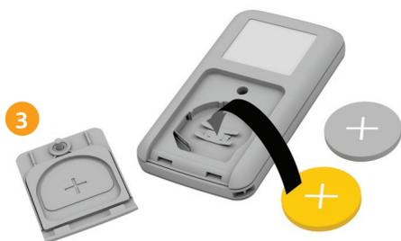
Inserte la pila nueva. Asegúrese de que el símbolo más “+” mire hacia arriba. Tenga cuidado para no dañar los contactos de la pila.
