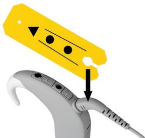
2 Empuje con cuidado el extremo ranurado del aplicador bajo el conector del cable de la bobina con los protectores de micrófono apuntando en dirección al procesador.
