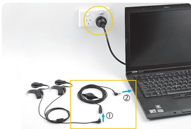
Conecte un cable personal de audio bilateral al cable aislante de suministro eléctrico de la misma forma.
