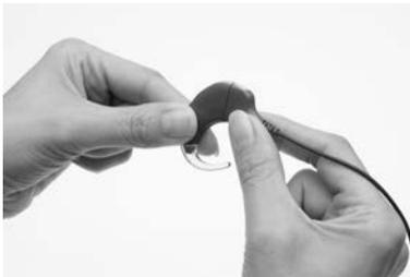
3. Gire suavemente la unidad de procesamiento y el conector superior hasta que las dos partes encajen.
