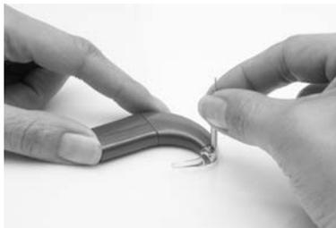
4. Empuje el pin de ajuste del codo con la herramienta de ajuste hasta que el pin esté completamente insertado. Asegúrese de que el pin no sobresale por ninguno de los lados del codo.
