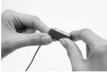
5. Gire suavemente el compartimento de las pilas y el conector inferior hasta que las dos partes encajen.
