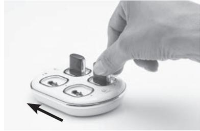
3. Gire el compartimento de pila recargable en el sentido de las agujas del reloj hasta que se encuentre en posición vertical.
