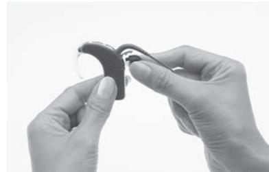
1. Levante cuidadosamente la tapa de la entrada de accesorios del procesador con un destornillador.
