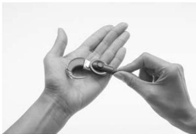
1. Coloque el imán de la bobina encima de las pilas de forma que el imán esté en contacto con ambas. El imán de la bobina levantará ambas pilas sacándolas del portapilas.
