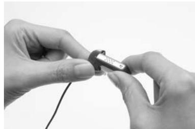
4. Sujete el compartimento de las pilas y el conector inferior del cable LiteWear (el extremo del cable que se conectará al compartimento de las pilas) de manera que se toquen. El conector inferior debe quedar a la derecha de la posición final, y el compartimento de las pilas a la izquierda de la posición final.
