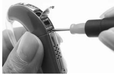
2. Con unas pinzas o un destornillador, presione el pasador hacia su izquierda para bloquear el compartimento de las pilas.
