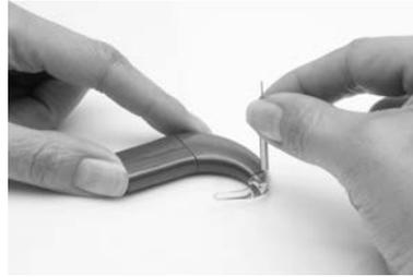
1. Acople el codo con fijación de seguridad a la unidad de procesamiento. Asegúrese de que el orificio del codo está alineado con el orificio de la unidad de procesamiento por el lado del codo (punta).
