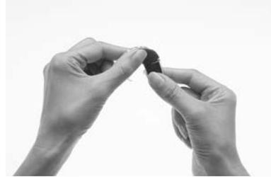
1. Sujete el compartimento de las pilas y la unidad de procesamiento de manera que entren en contacto. El compartimento de las pilas debe quedar a la izquierda de la posición final, y la unidad de procesamiento a la derecha de la posición final.
