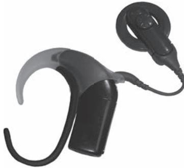
Figura 9: Snugfit acoplado al procesador
