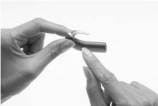
3. Asegúrese de que el compartimento de las pilas está correctamente alineado. Compruebe que no haya contactos rotos o doblados entre el compartimento de las pilas y la unidad de procesamiento, ya que podrían causar desalineación. Si hay algún contacto roto, devuelva el procesador a su especialista clínico.
