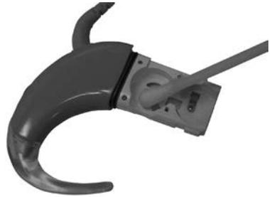
1. Retire las pilas del portapilas.
