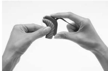
1. Sujete el procesador con una mano y la cubierta con la otra, tal como se muestra.
