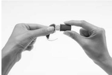
4. Vuelva a colocar la tapa de las pilas deslizándola hacia arriba desde la parte inferior del portapilas hasta la unidad de procesamiento. No fuerce la tapa al introducirla; debería deslizarse fácilmente.
