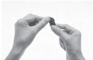
1. 電池モジュールとプロセシングユニットの接続面がかみ合うよう、電池モジュールを右側に、プロセシングユニットを左側に持ちます。
