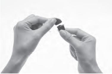
1. 電池モジュールをプロセッシングユニットから外します。
