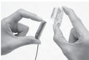
1. ライトウェアケースにアクセサリクリップが取り付けられていない場合、電池モジュールを挿入する前に取り付けてください。詳細は「ライトウェア用アクセサリクリップを使用する」をご参照ください。
