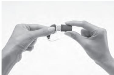
2. 電池カバーを電池ホルダから外します。
