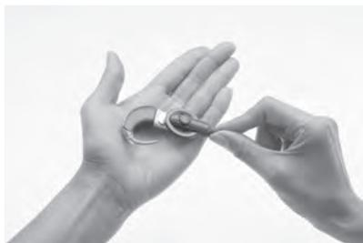
1. マグネットを電池の上に持っていきます。マグネットの磁力で2個の電池を電池ホルダーから持ち上げます。
