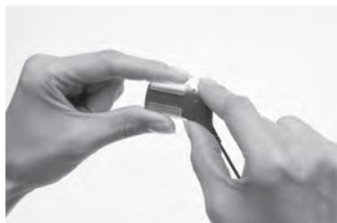
3. ケーブルの下部シュー部分を持って、電池モジュールをライトウェアケースに挿入します。電池モジュールはどちらの面が上でも挿入できます。
