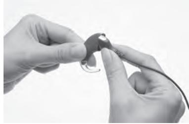
2. プロセッシングユニットとライトウェアケーブルの上部シュー（プロセッシングユニットに接続する側）の接続面を図のようにかみ合わせます。
