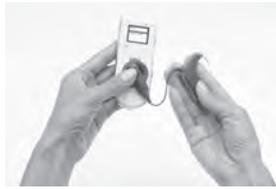
図14:送信コイルをリモートアシスタントの裏面に置く
