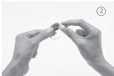
3. 電池を取り出すには、図のように、電池ホルダをどちらか側に傾けるか (1)、指で取り出します (2)。
