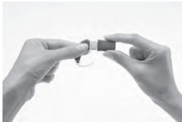
4. 電池カバーを、電池ホルダの下部からプロセッシングユニットに向けてスライドさせて取り付けます。電池カバーは簡単にはまりますので、無理に押し込まないでください。
