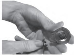
1. 送信コイルの裏面が上を向くように、送信コイルと送信ケーブルを持ちます。送信コイル裏面の、送信コイルと送信ケーブルの間に爪を押し入れるようにすると外しやすくなります。
