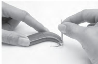
1. 固定ピン付きイヤフックをプロセッシングユニットに取り付けます。イヤフックの穴が、プロセッシングユニットにある穴と重なるようにします。
