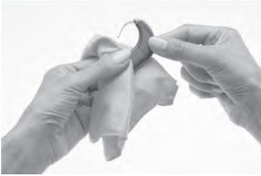
1. 電池カバーを取り外す前に、乾いた柔らかい布でサウンドプロセッサを拭きます。
