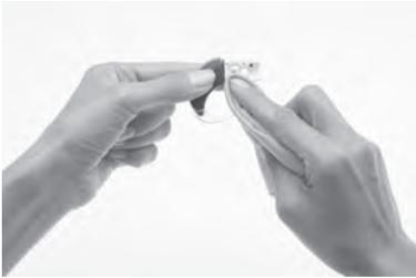
4. 電池ホルダーと電池カバーの内側と外側を乾いた柔らかい布で拭き、水分、湿気、汗を取り除きます。
