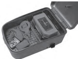
4. プロセッシングユニット、送信コイル、送信ケーブル、電池カバーを Dry & Store® に入れます。電池ホルダはプロセッシングユニットに付けたまま入れてください。
