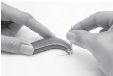
4. 固定用ツールを使用して、固定ピンが完全に挿入されるまで押し込みます。ピンがイヤフックのどちら側からも突き出ていないことを確認してください。
