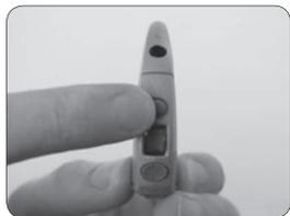
選択ボタンを数秒間押し続けて、サウンドプロセッサを起動、または停止させます。
