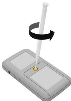
Déverrouillez le cache piles en dévissant dans le sens inverse des aiguilles d'une montre à l'aide d'un petit tournevis cruciforme.
