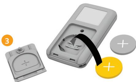
Insérez la nouvelle pile. Vérifiez que le signe « + » se trouve sur le dessus. Veillez à ne pas endommager les contacts de pile.
