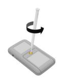
Déverrouillez le cache piles en dévissant dans le sens inverse des aiguilles d'une montre à l'aide d'un petit tournevis cruciforme.
