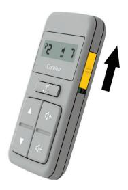
Lorsque l'interrupteur est en position de marche, la télécommande se met en veille si elle n'est pas utilisée. Pour le remettre en marche, appuyez sur n'importe quelle touche.
