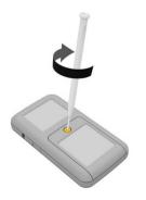
Verrouillez le cache piles en vissant entièrement la vis dans le sens des aiguilles d'une montre à l'aide d'un petit tournevis cruciforme.
