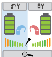
Figure 34 : Ecran de l'état de la pile du processeur en mode bilatéral
