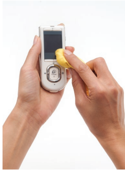
Figure 64 : Nettoyage de l'assistant sans fil en l'essuyant avec un chiffon doux et sec
