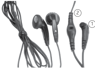
Figure 2 : Connecteur du processeur (1) et connecteur d'accessoires (2) sur les écouteurs
