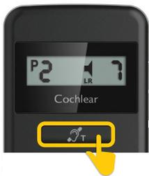
Drücken Sie einmal kurz auf die Telefonspulentaste. Daraufhin wird das Zubehörsymbol nicht mehr angezeigt.
