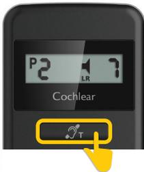
Zum Beenden der Audioübertragung drücken Sie kurz auf die Telefonspulentaste. Daraufhin wird das Zubehörsymbol nicht mehr angezeigt.
