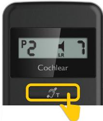
Drücken Sie einmal kurz auf die Telefonspulentaste. Daraufhin wird das Telefonspulensymbol nicht mehr angezeigt.
