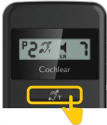
Drücken Sie einmal kurz auf die Telefonspulentaste. Daraufhin wird das Telefonspulensymbol angezeigt.
