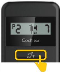
Zum Starten der Audioübertragung drücken Sie lange auf die Telefonspulentaste. Daraufhin wird das Zubehörsymbol angezeigt.
