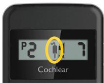
Angeschlossenes Plugin-Audiozubehör können Sie mit der Bedienhilfe aus- und einschalten.
