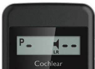
Wenn sich der Soundprozessor außerhalb der Reichweite der Bedienhilfe befindet oder die Verbindung gestört ist, werden am Bildschirm der Bedienhilfe waagerechte Striche angezeigt (siehe links).
