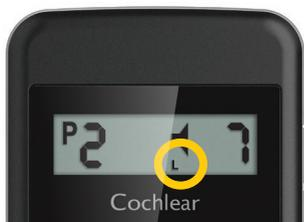
Danach wird am Bildschirm der Bedienhilfe die erfolgreiche Synchronisation des linken (L) beziehungsweise rechten (R) Soundprozessors angezeigt.
