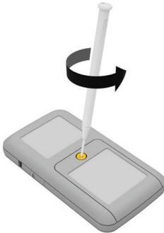
Drehen Sie die Schraube der Batterieabdeckung mit einem kleinen Kreuzschlitzschraubendreher entgegen dem Uhrzeigersinn heraus.
