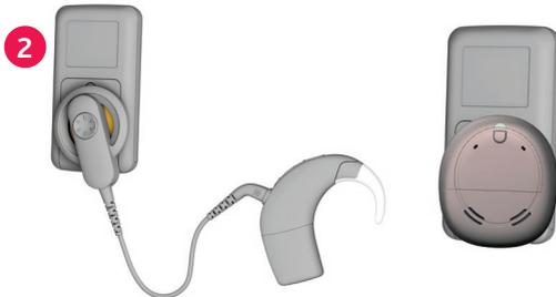
Setzen Sie die Spule/den Soundprozessor auf die Rückseite der Bedienhilfe auf.
