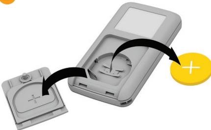
Schieben Sie die Batterieabdeckung aus der Führung, und entnehmen Sie die Batterie.
