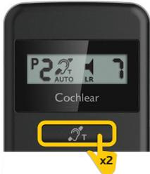
Drücken Sie zweimal kurz auf die Telefonspulentaste. Daraufhin werden das Telefonspulensymbol und der Hinweis AUTO angezeigt.
