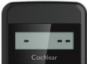
Ist die Bedienhilfe nicht mit einem Soundprozessor synchronisiert, zeigt die Anzeige ausschließlich waagerechte Striche an (siehe links), die bei Tastendruck blinken.
