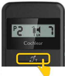
Drücken Sie einmal kurz auf die Telefonspulentaste. Daraufhin wird das Zubehörsymbol angezeigt.
