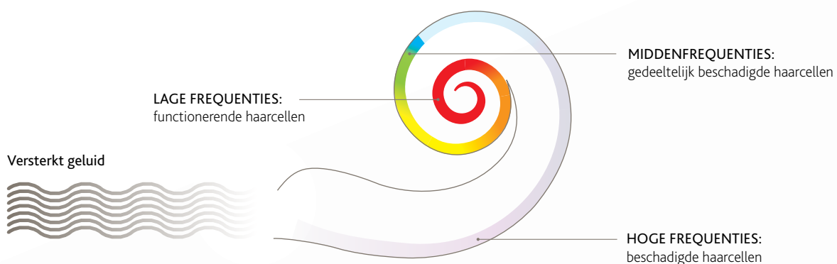
Afbeelding 4b: De werking van het slakkenhuis met een conventioneel hoortoestel
